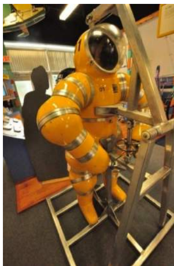
Les scaphandres rigides testés à vide à plus de 90 bars offrent un bon exemple de ce à quoi pourrait ressembler un scaphandre vénusien.
